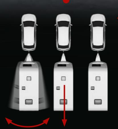
En cas de vent de latéral, dépassement ou débrayage le véhicule peut très vite provoquer un mouvement de mise en lacets. L'ATC – AL-KO Trailer Control agit activement et remet votre caravane dans sa trajectoire.
