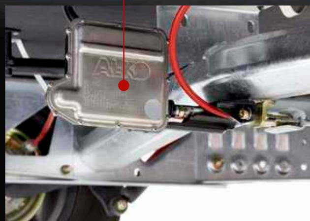
Système anti-dérive électromécanique ATC (AL-KO Trailer Control)
