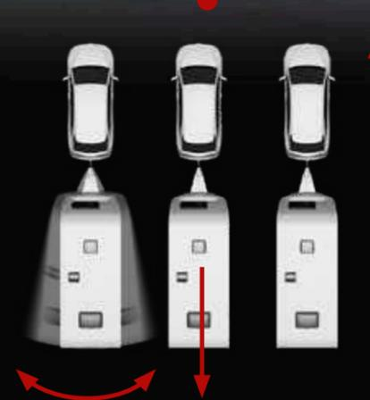
En cas de vent latéral, de dépassement ou de manœuvres d'évitement, l'AL-KO Trailer Control ramène automatiquement l'attelage sur la bonne voie.
